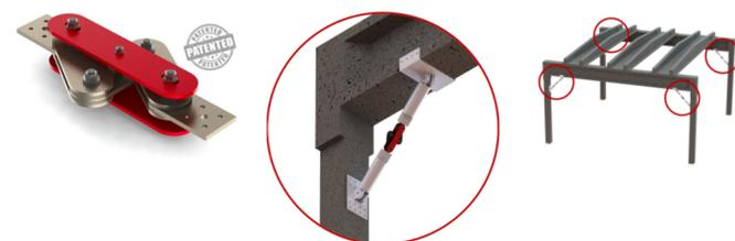
DoubleDamp, è un dispositivo di connessione dissipativa bidirezionale per la protezione sismica delle costruzioni prefabbricate in calcestruzzo armato e calcestruzzo armato precompresso che viene montato in corrispondenza dei nodi trave-colonna della struttura, per garantire il collegamento tra gli elementi strutturali principali e la dissipazione energetica necessaria per salvaguardare il fabbricato dal terremoto.
